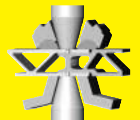
Hohlkammerprofil, einseitig offen mit Möglichkeit zum Ausgleich von Breittoleranzen zum beidseitigen FSW-Schweißen
