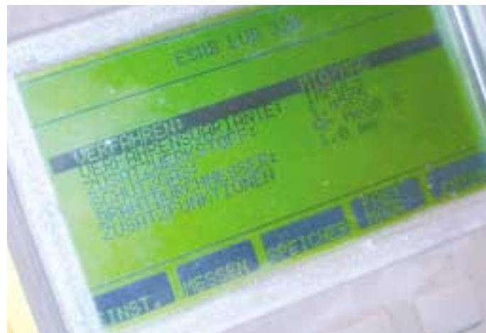
▼ Menuegeführte Kennlinienabfrage an der LUD 320
