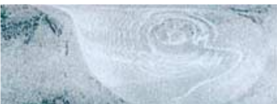
Querschliff mit charakteristischer Zwiebelringstruktur der FSW-Schweißung
