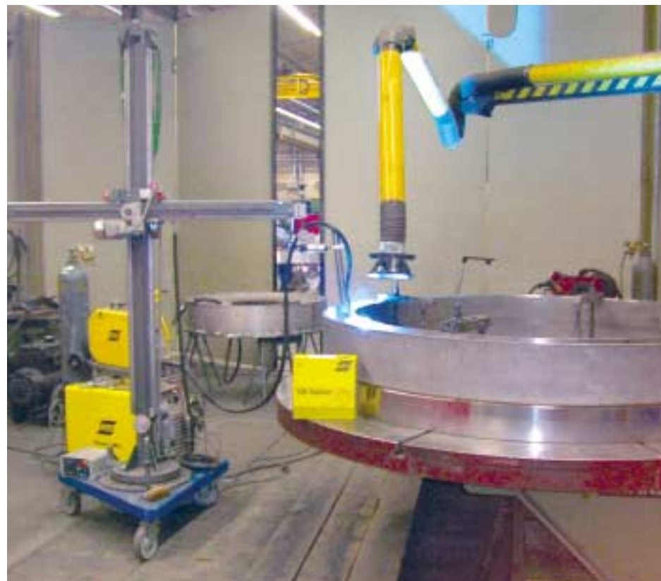
Einsatz des hochlegierten Metallpulver-Fülldrahtes OK Tubrod 15.31 – T 19 12 3 LM 2 EN 12073 bei der Fertigung eines Ringkessels für Flaschenfüller
